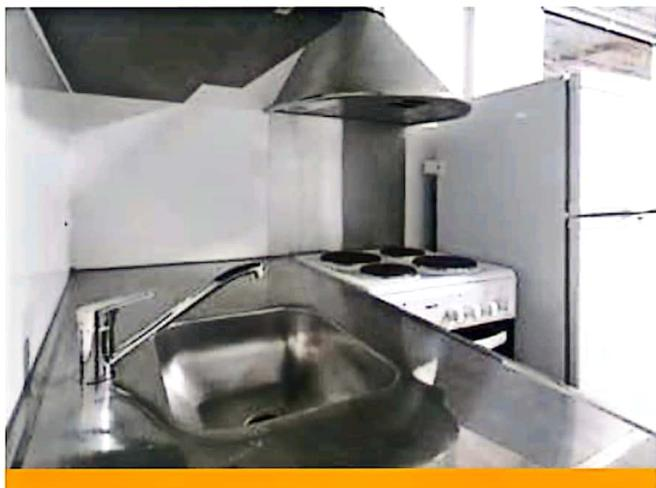
correderas telescópicas con cierre suave, y las manijas son de aluminio anodizado. La mesada es de acero inoxidable con grifería marca FV, acompañada con un revestimiento de pared sobre mesada de PRFV para una mejor limpieza y protección. Sobre la cocina eléctrica de 4 hornallas y debajo de la campana extractora de acero
